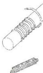
13 Curvar o arame num corpo cilíndrico
