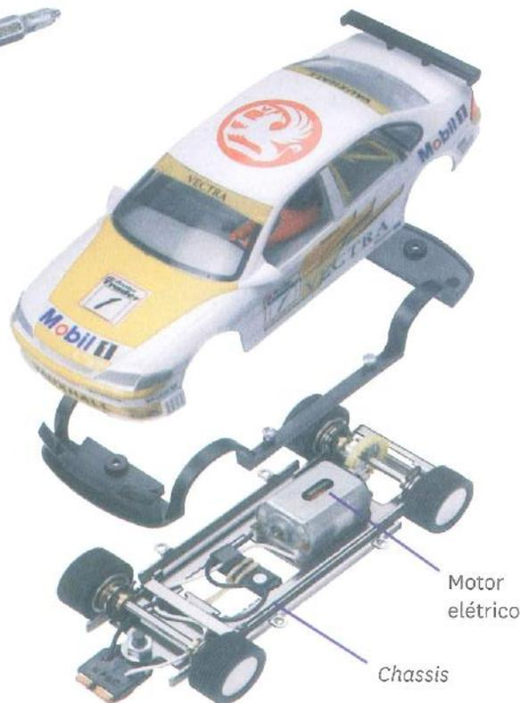
4 Motor elétrico montado no chassis do carrinho. Este carrinho circula numa estrutura – pista – eletrificada através do contacto metálico situado na frente do chassis.
